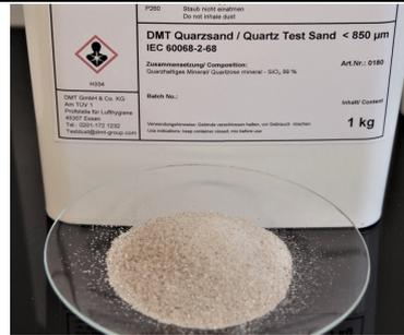
**1. Allgemeine Beschreibung:** In der Norm 60068-2-68 werden Prüfverfahren festgelegt, um die Effekte von Staub und Sand als Bestandteil der Luft auf elektrotechnische Produkte zu bestimmen. Für die Prüfung Lc nach Methode Lc1 und Lc2 wird der DMT Quarzsand < 850 µm eingesetzt.
