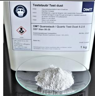
**1. Allgemeine Beschreibung:** Mit Hilfe des DMT Quarzstaubs entsprechend chapter 3-19 5.2.5 und 3-25 5.2. (a) iii des Standards DEF-Stan 00-35 werden das Erosionsverhalten und die Bildung von Strukturschäden im Flug durch Staub simuliert.
