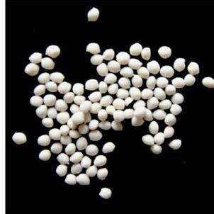
**1. Allgemeine Beschreibung:** Die DMT Kunststoffgranulate sind Polymerkugeln, die gemäß Kapitel 5.7 zur Bestimmung des höchsten nutzbaren Volumens eines Staubsaugerbehälters dienen. Dabei wird zunächst die Masse für einen Liter an Granulate ermittelt und mit der im Staubsaugerbehälter eingesaugten Granulatmasse das Volumen des Staubsaugerbehälters bestimmt. Die Spezifikation ist in der folgenden Tabelle dargestellt.
