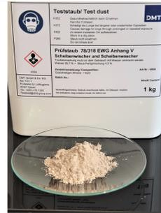
**1. Allgemeine Beschreibung:** Der DMT Staub ist die Trockenmischung gemäß 78/318/EWG, die für die Prüflüssigkeit verwendet wird.
