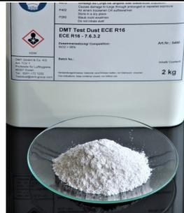
**1. Allgemeine Beschreibung:** Der Prüfstaub gemäß ECE R 16 wird für die Prüfung der Staubfestigkeit von Aufrolleinrichtungen verwendet.
