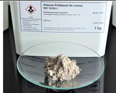
**1. Allgemeine Beschreibung:** Der größte Prüfstaub der ISO 12103-1 ist der Arizona Prüfstaub A4 coarse. Der sogenannte Arizona Prüfstaub A4 coarse besteht 69 % – 77 % aus Quarz.
