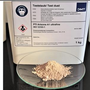
**1. Allgemeine Beschreibung:** Der Arizona Prüfstaub A1 ultrafine bildet den feinsten Normstäube der ISO 12103-1 und wird für verschiedene Filter- und Umweltprüfungen verwendet. Der sogenannte Arizona Prüfstaub A1 ultrafine besteht zu 69 % – 77 % aus Quarz.
